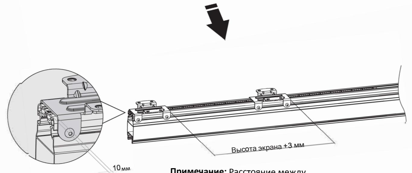
**Примечание:** Расстояние между соединительными пластинами должно быть равно высоте панели + 3 мм
