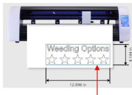
После применения функции Auto Weed-Box («Автоматическое создание рамки обрезки») – синяя рамка вокруг задания указывает линии обрезки для выборки
