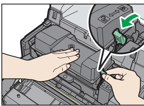
3. Сожмите фиксатор на принт-картридже и поднимите картридж.
