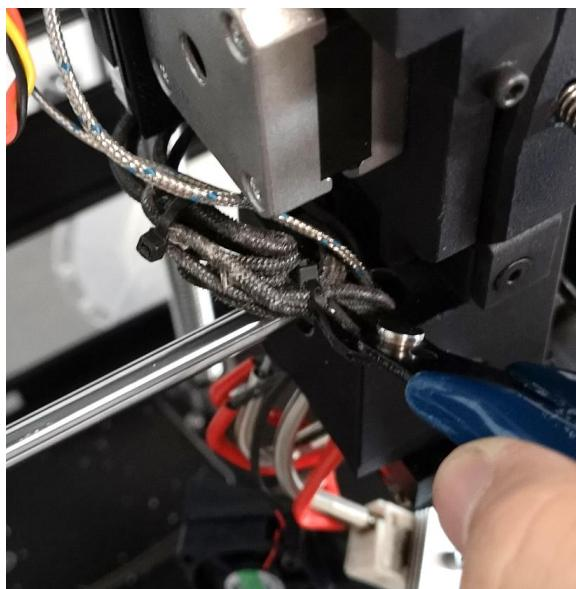
Ослабьте винты, отмеченные на следующем рисунке. Извлеките кабеля нагревателя.
