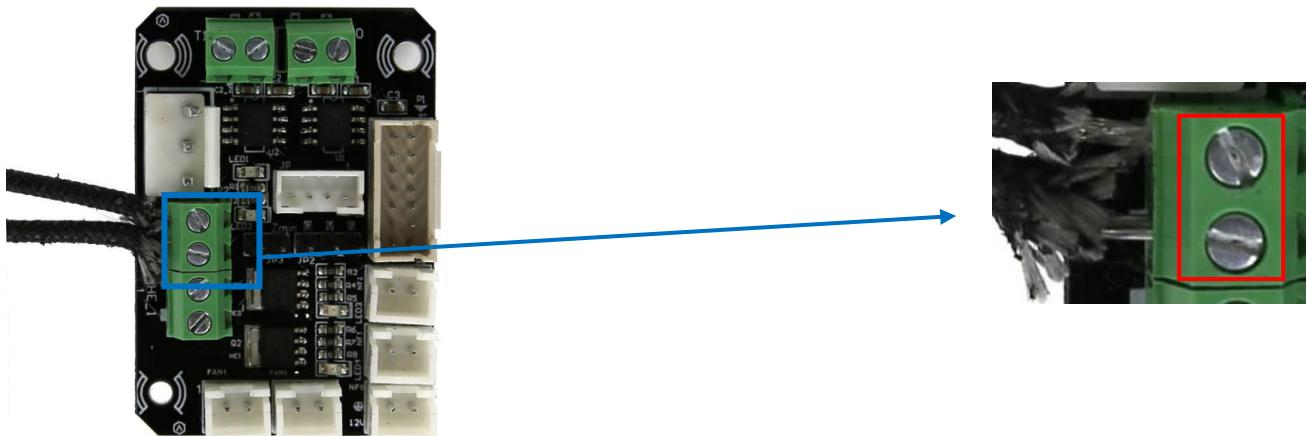
Вытяните кабели нагревательного элемента из блока снизу.
