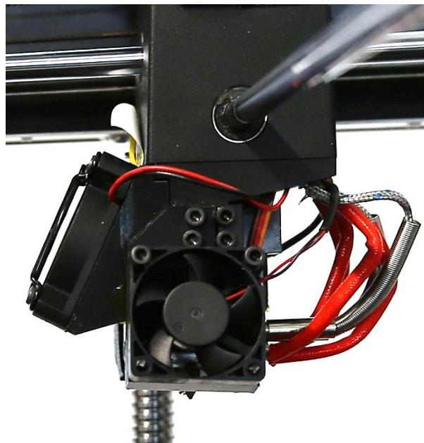
Пинцетом протолкните разъем нового вентилятора через монтажный блок.
