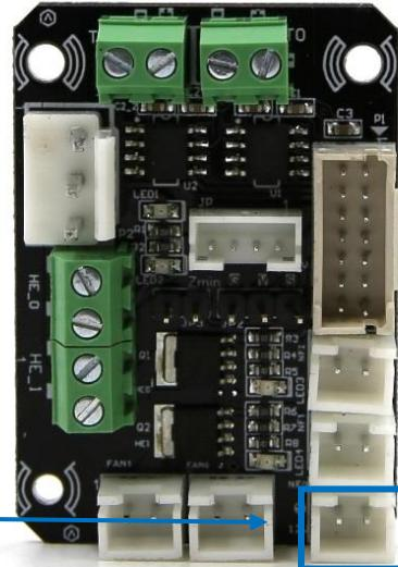
Вставьте кабель нагревателя в разъем и затяните винты для того, чтобы зафиксировать провод.
