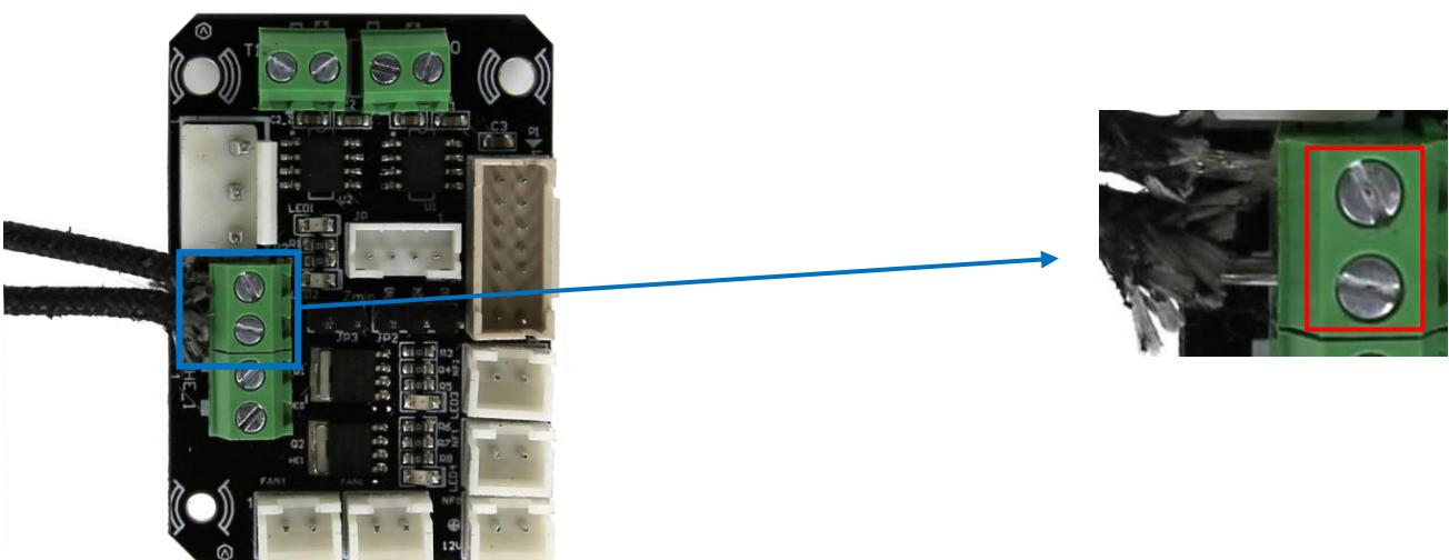
Вытяните кабели нагревательного элемента из блока снизу.
