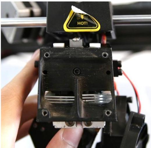
Зафиксируйте защитную крышку и вентилятор на воздуховод 4 винтами.
