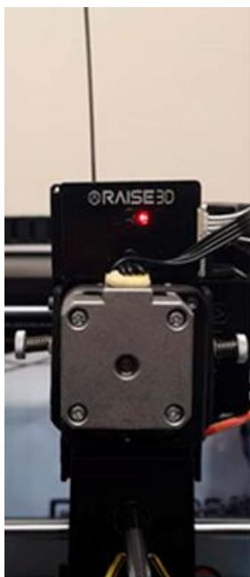
a. Если засор расположен между датчиком окончания филамента и экструдером, перейдите ко второму шагу.
