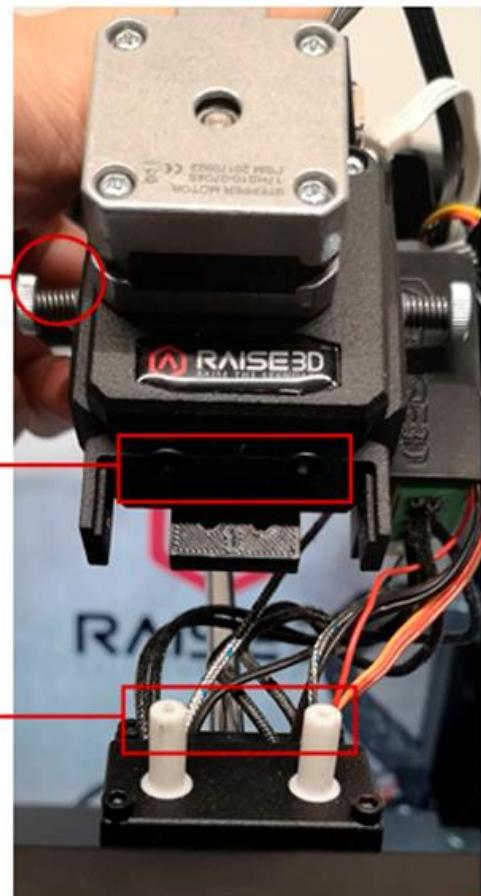
Если засор находится у входа в PTFE трубки в держателе экструдера, выньте его.
