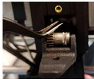
Если засор находится внутри экструдера, протяните инструмент для прочистки сопла через экструдер для проталкивания засора наружу.
