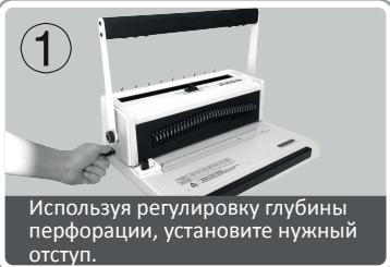
Используя регулировку глубины перфорации, установите нужный отступ.
