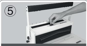
Отрегулируйте степень сжатия пружины с помощью переключателя.
