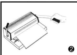
Опустите рычаг перфорации для пробивки отверстий.
