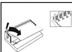
Вставьте листы в открытую пластиковую пружину. Верните рычаг зажима пружины в горизонтальное положение.
