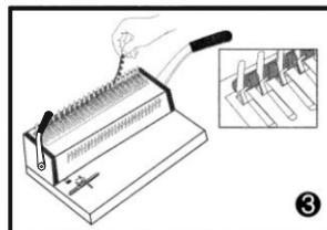
Поместите пластиковую пружину за держатель переплетного механизма зубцами вверх.
