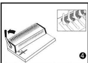
Пользуясь рычагом зажима откройте пластиковую пружину.
