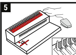
Используйте ручку разжима пружины на боковой панели, разожмите пружину.
