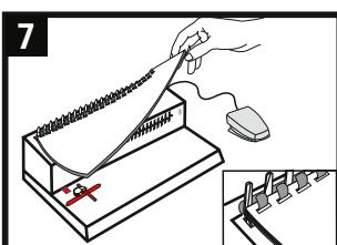
Снимите готовую брошюру с переплетного механизма.
