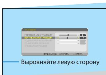
**7. Нажмите кнопку ▲, чтобы выбрать [ГОРИЗОНТАЛЬН ТРАПЕЦИЯ], а затем с помощью кнопок ◀ или ▶ настройте изображение так, чтобы верхняя и нижняя стороны проекции стали параллельными.**
