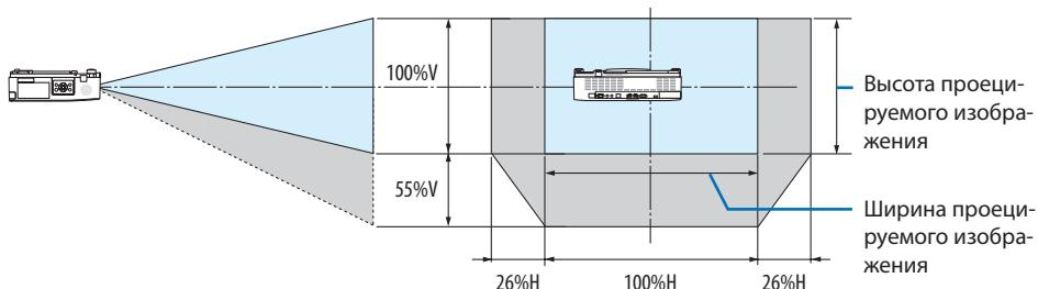
(Пример) При проецировании на 150-дюймовый экран
