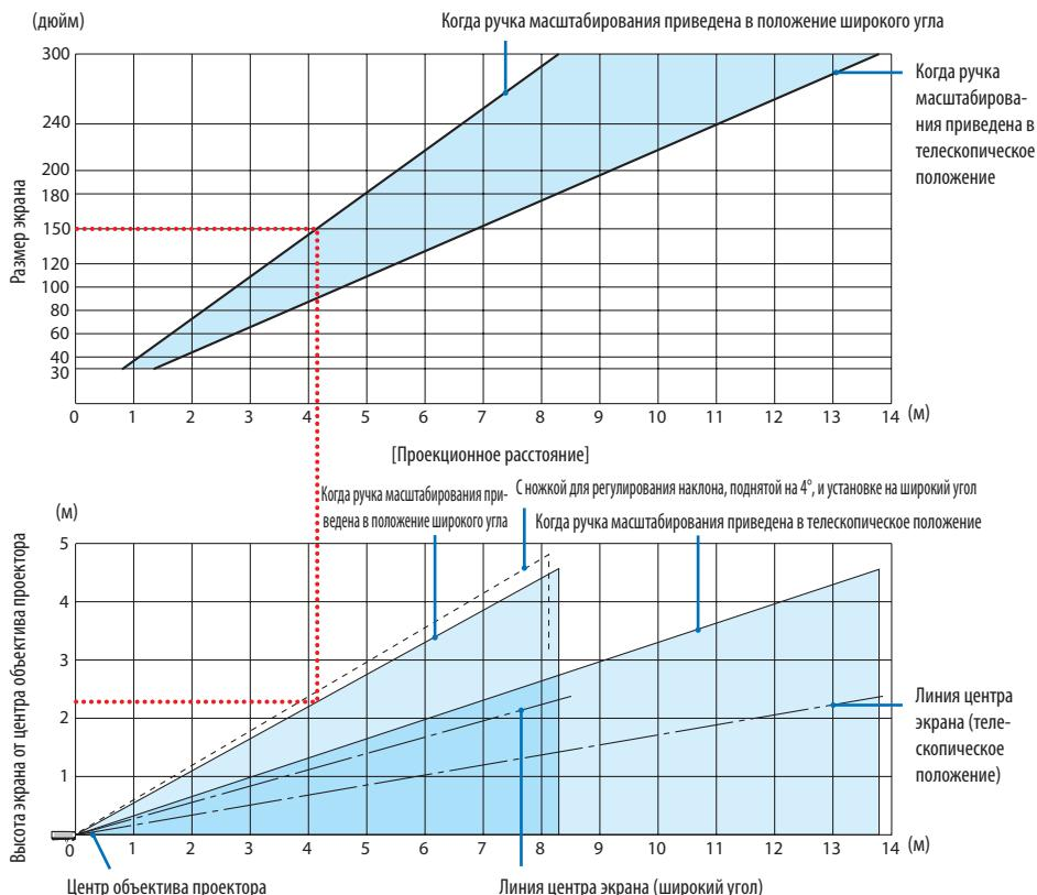
\* Значения «высоты экрана от центра объектива проектора» в таблице проекционных расстояний указаны при сдвиге объектива 50% V.
