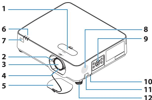
1. Крышка механизма сдвига объектива
