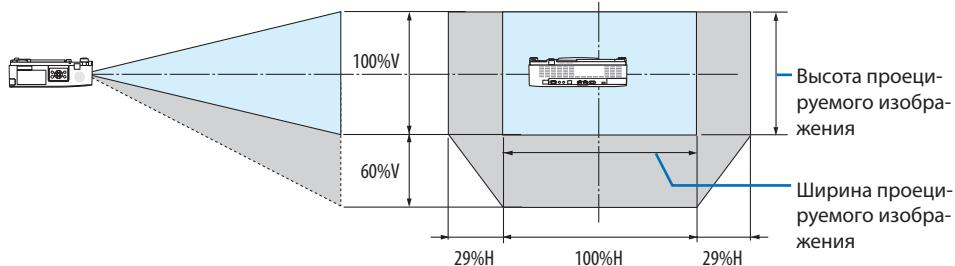
(Пример) При проецировании на 150-дюймовый экран
