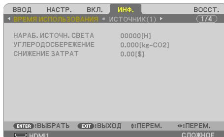
Отображает состояние текущего сигнала и время использования светового модуля. Этот элемент содержит девять страниц. Включена следующая информация:
