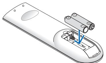
3. Установите крышку над отсеком для элементов питания и задвиньте ее до щелчка. Не используйте одновременно элементы различных типов или новые элементы вместе со старыми.
