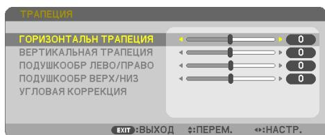
Вы можете вручную откорректировать трапециевидные искажения по вертикали и горизонтали, а также подушкообразное искажение слева/справа и сверху/снизу и угловое искажение.
