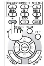
Если проектором можно управлять, используя текущий идентификатор для пульта ДУ, то на экране отобразится [КОНТРОЛЬ ID (АКТИВНЫЙ)]. Если проектором нельзя управлять, используя текущий идентификатор для пульта ДУ, то на экране отобразится [КОНТРОЛЬ ID (НЕАКТИВНЫЙ)]. Чтобы управлять неактивным проектором, задайте [КОНТРОЛЬ ID], используемый для проектора, выполнив следующую процедуру (шаг 3).
