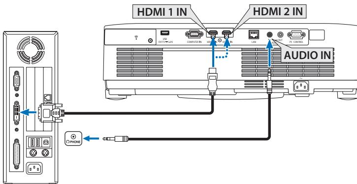
Подключите аудиовыход компьютера к разъему AUDIO IN проектора. В этом случае измените настройку [HDMI1] или [HDMI2] в экранном меню [ВКЛ.] → [ОПЦИИ(1)] → [ВЫБОР АУДИО] на [КОМПЬЮТЕР]. (→ стр. 75)
