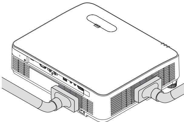
Удалите пыль с вентиляционных отверстий или динамиков с помощью пылесоса.
