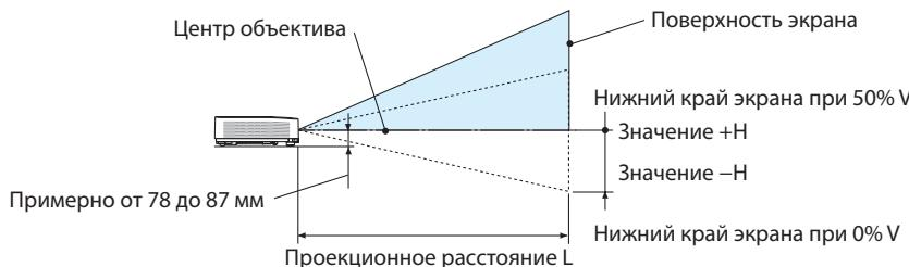
(Примечание) Высота от центра объектива до нижнего края экрана (с вкрученной ножкой для регулирования наклона)
