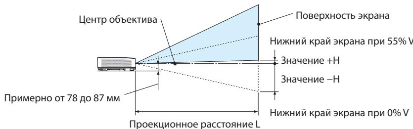
(Примечание) Высота от центра объектива до нижнего края экрана (с вкрученной ножкой для регулирования наклона)
