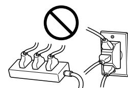
Не используйте удлинители. Использование удлинителя может стать причиной возгорания или поражения электрическим током. Если шнур питания из комплекта поставки недостаточно длинный для подсоединения к стенной розетке, обратитесь в техническую службу.
