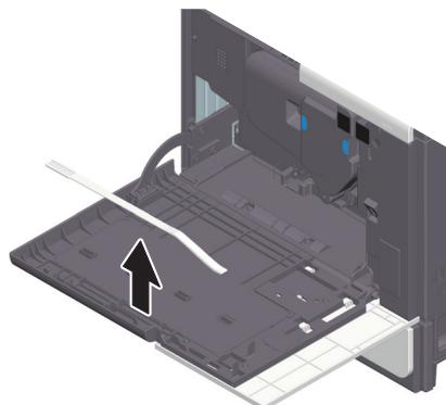
**4 Медленно вставьте очиститель печатающей головки до конца задней части линзы печатающей головки, а затем медленно вытяните назад.**
