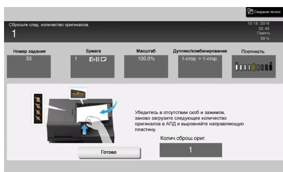
Загрузите оригинал или бумагу и нажмите [OK] или [Готово]. Система снова запускает процесс сканирования или печати оригинала.
