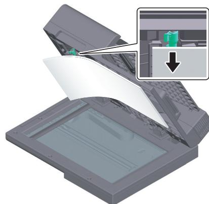
→ Расфиксируйте рычажок блокировки **открывающей и закрывающей направляющей** и откройте **открывающую и закрывающую направляющую**.
