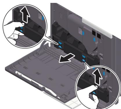
**3 Снимите очиститель печатающей головки с передней дверцы аппарата.**
