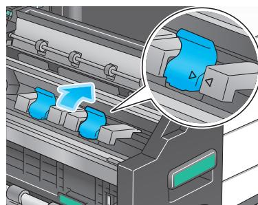
**11** Задвиньте устройство изготовлению брошю.
