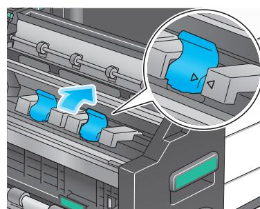
**11** Задвиньте устройство изготовлению брошюр.
