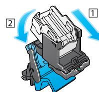
**8** Закройте крышку картриджа со скобами для брошюрования.
