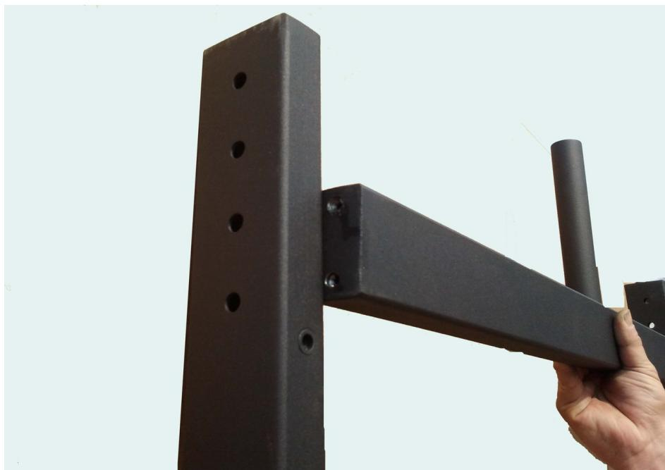
Затяжку верхней перемычки производить убедившись в строго вертикальном положении опоры для держателя проектора.
