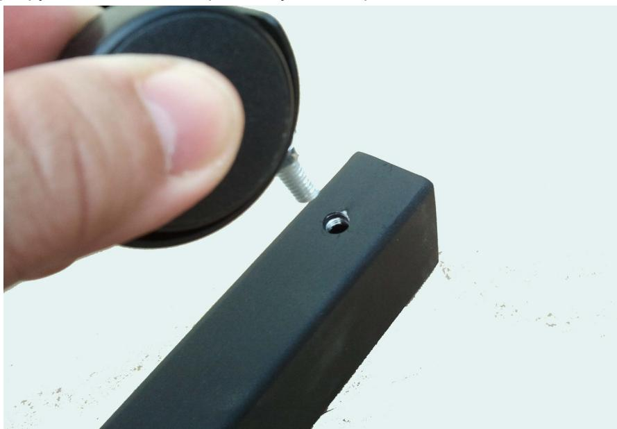
2) При этом опоры с тормозным механизмом крепить к скошенной части
