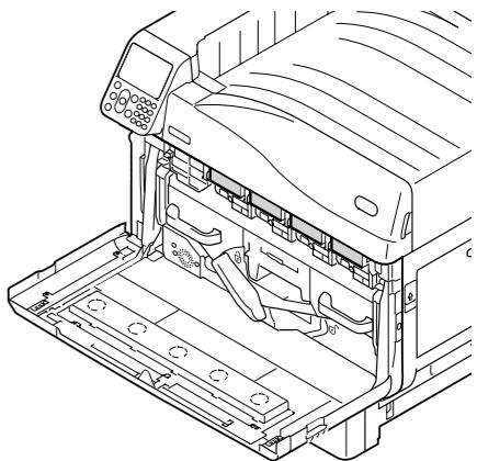
**4** Слегка приподнимите ручку (синий) вверх и осторожно извлеките фотобарабан, чтобы ваши руки не касались барабана в нижней части (цилиндрический отсек зеленого цвета).
