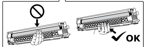
**5** Извлеките емкость для отработанного тонера из принтера.
