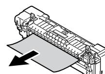
**8** Если бумага намоталась на ролик декалькомании, извлеките устройство для декалькомании, повернув влево барашковые винты с обеих сторон устройства для декалькомании, и извлеките бумагу.
