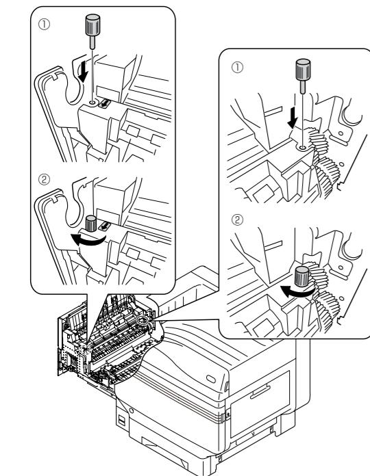
**11** Установите устройство для декалькомании в исходное положение и закрепите двумя барашковыми винтами.
