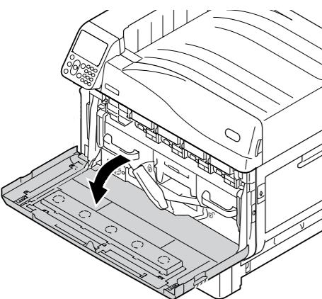
3 Извлеките емкость для отработанного тонера из принтера.
