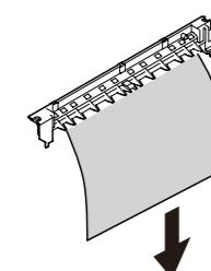
**9** Установите устройство для декалькомании в исходное положение и закрепите двумя барашковыми винтами.
