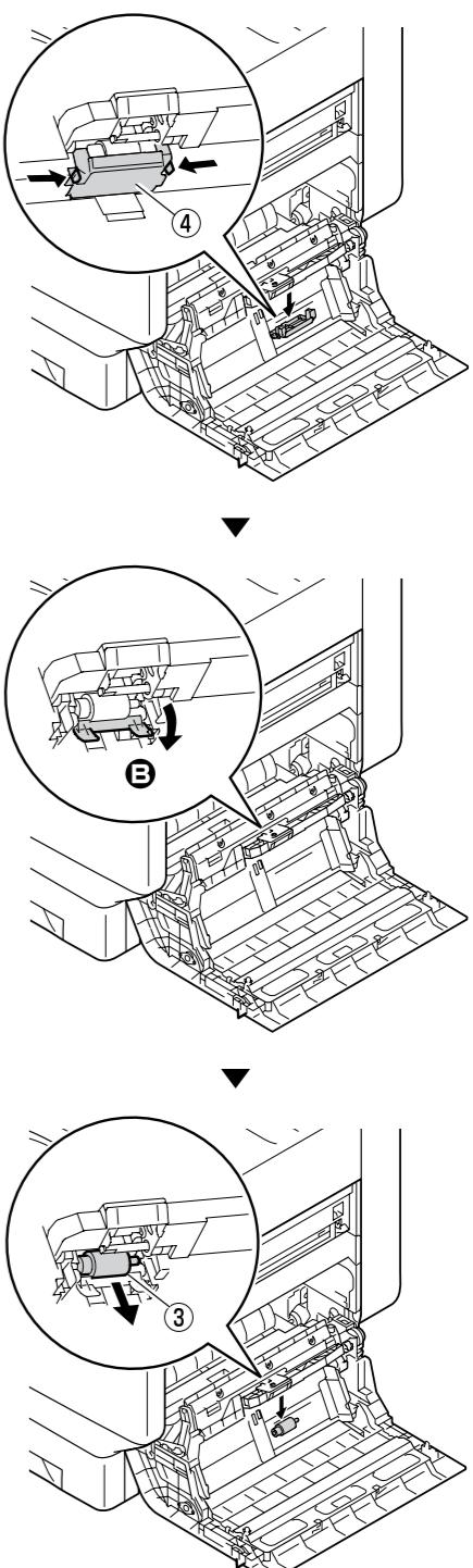
**8** Плотно установите новый отделяющий ролик (③) вдоль выемки и закрепите разделитель (④).
