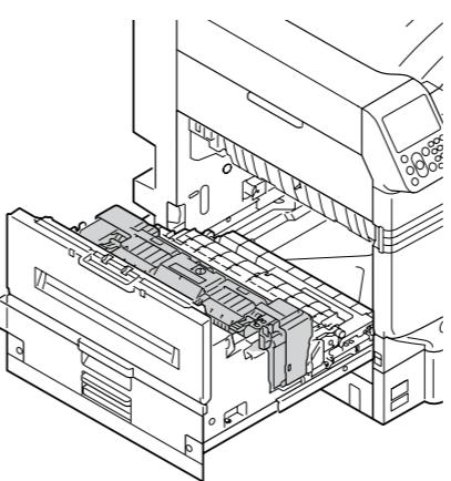
**13** Нажмите фиксирующий рычаг термофиксатора (синий).
