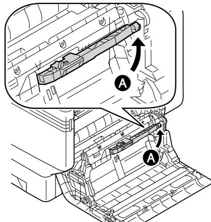
**7** Удалите пыль с роликов подачи бумаги (в двух местах) и разделителя влажной мягкой тканью.
