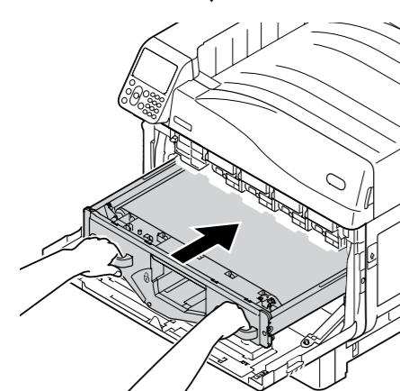
**11** Приподнимите левый/правый фиксирующий рычаг ремня переноса изображения, вращайте рукоятку рычага с фиксацией (синий) вправо и зафиксируйте ее.
