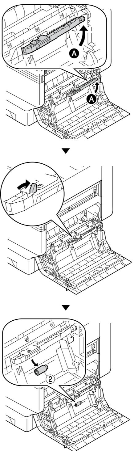
**7** Возьмитесь за зажимы с двух сторон и извлеките разделитель (④). Откройте Отсек В и извлеките отделяющие ролики (③).
