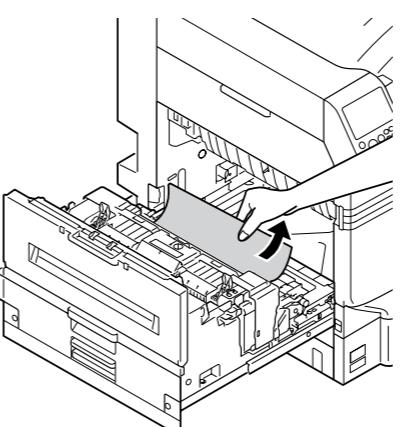
**4** Нажмите рычаг высвобождения бумаги термофиксатора (синий).
