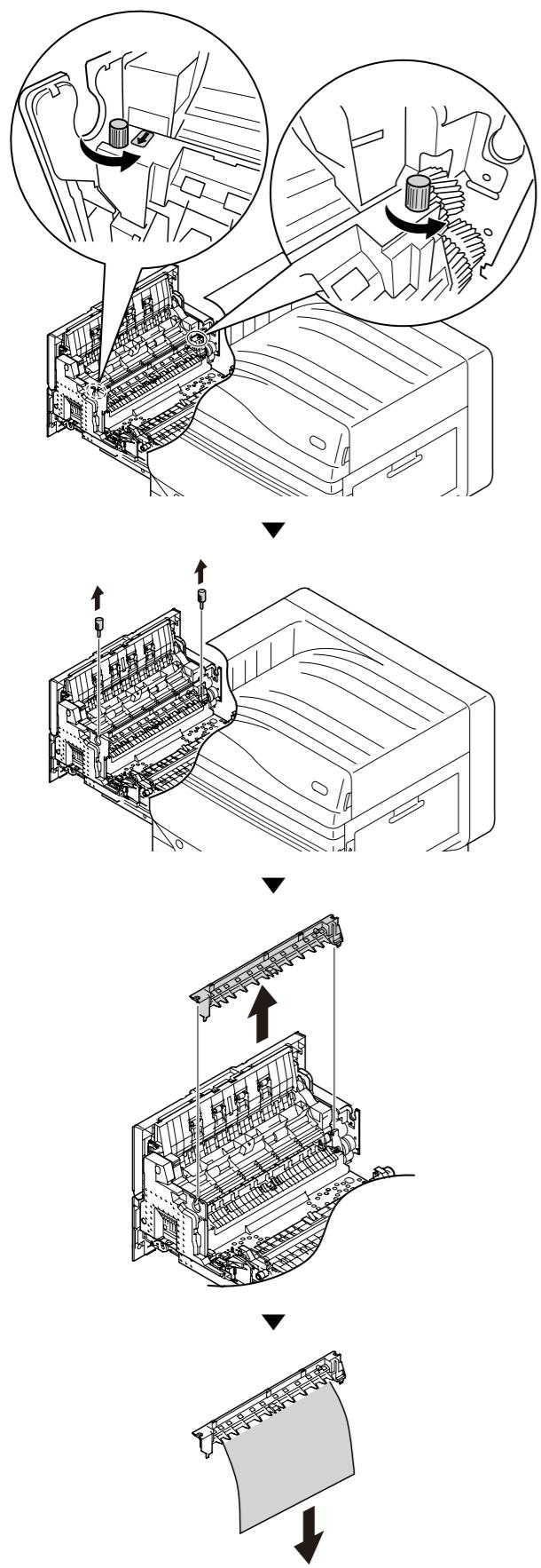
**8** Установите устройство для декалькомании в исходное положение и закрепите двумя барашковыми винтами.
