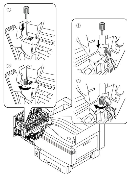
**9** Установите устройство для декалькомании в исходное положение и закрепите двумя баращковыми винтами.
