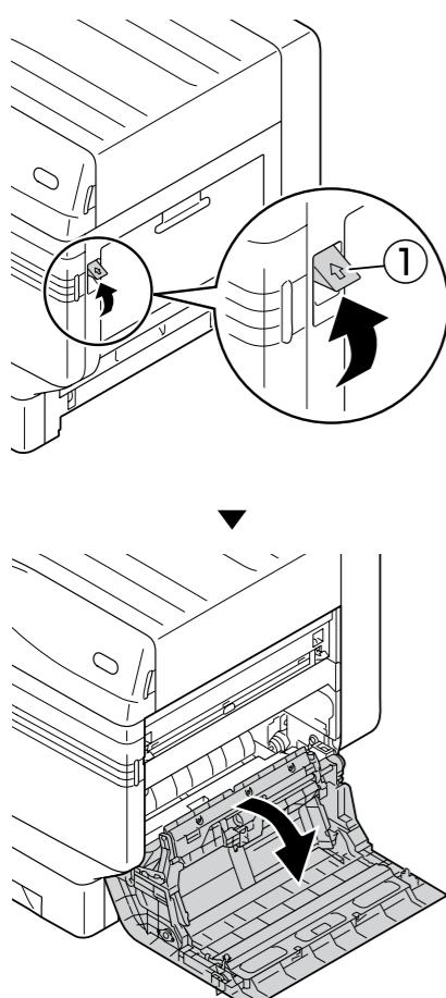
**5** Откройте зажимы роликов подачи (①) в противоположном направлении и снимите их с оси.
