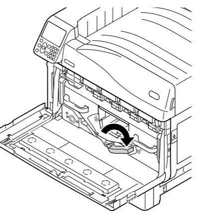
**5** Вращайте левую/правую рукоятку рычага с фиксацией (синий) ремня переноса изображения влево, а затем потяните фиксирующий рычаг на себя.
