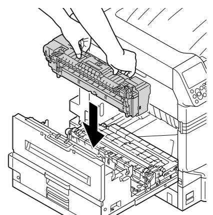
**12** Нажмите фиксирующий рычаг термофиксатора (синий).
