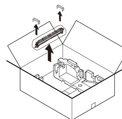
**18** Установите новый ролик переноса изображения в выходной блок.
