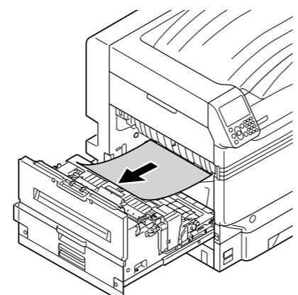
**6** Если край бумаги не виден, потяните фиксирующий рычажок термофиксатора (синий).
