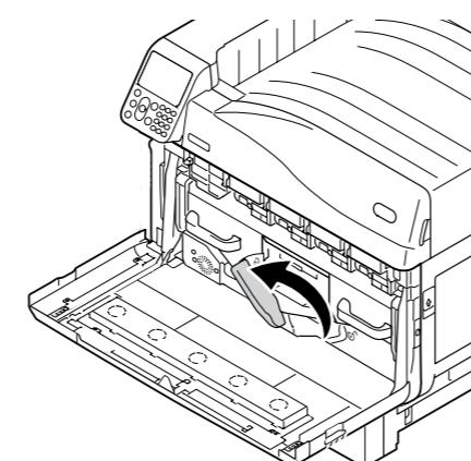
**13** Установите емкость для отработанного тонера в принтер.
