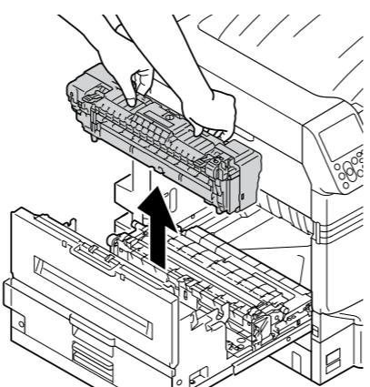
**8** Поднимите стопорный рычаг (синий) освобождения замятой печки.
