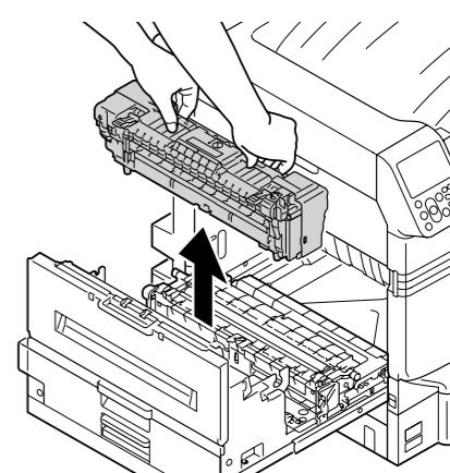
**7** Если бумага намоталась на ролик декалькомании, извлеките устройство для декалькомании, повернув влево барашковые винты с обеих сторон устройства для декалькомании, и извлеките бумагу.
