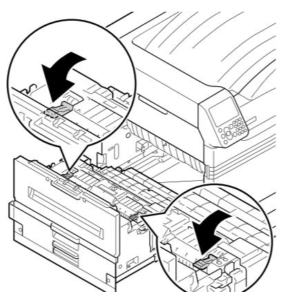
**6** Если в термофиксаторе не осталось бумаги, потяните фиксирующий рычажок термофиксатора (синий).
