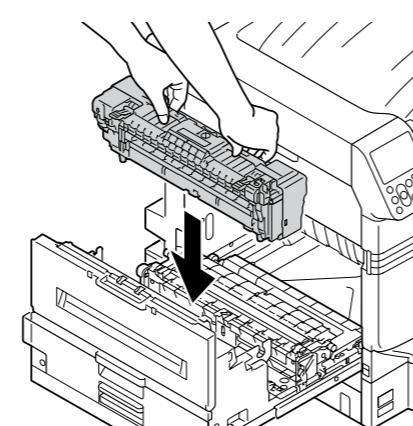
**11** Нажмите фиксирующий рычаг термофиксатора (синий).
