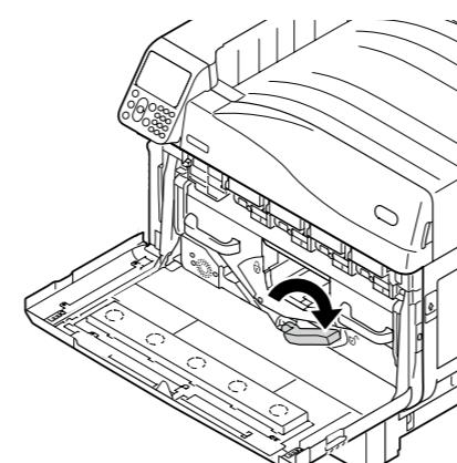
**7** Вращайте левую/правую рукоятку рычага с фиксацией (синий) ремня переноса изображения влево, а затем потяните фиксирующий рычаг на себя.
