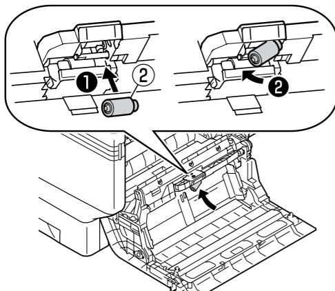
**10** Закрепите новые ролики подачи бумаги (①) на оси и плотно прижмите их изнутри, одновременно вращая.
