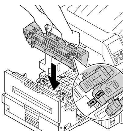
**13** Нажмите на стопорный рычаг (синий) блока печки.
