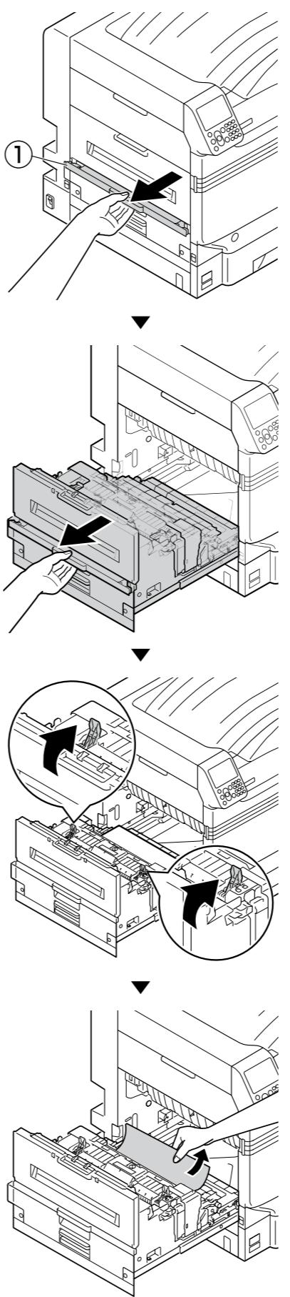
**5** Если край бумаги не виден, потяните фиксирующий рычажок термофиксатора (синий).
