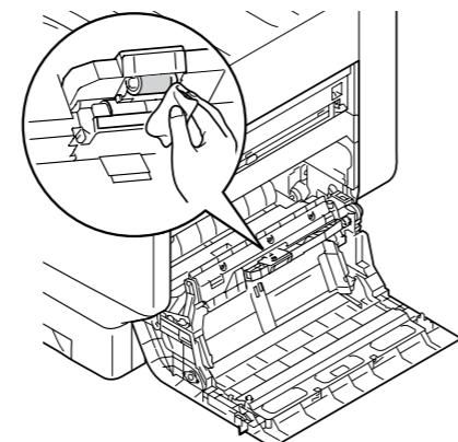
**8** Закрепите новые ролики подачи бумаги (①) на оси и плотно прижмите их изнутри, одновременно вращая.
