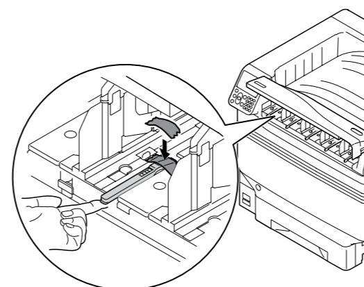
**7** Повторите шаги 5 и 6 для остальных рычагов определения тонер-картриджей.
