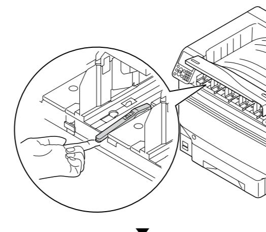
**6** С помощью липкой ленты зафиксируйте рычаг тонер-картриджа в поднятом положении.
