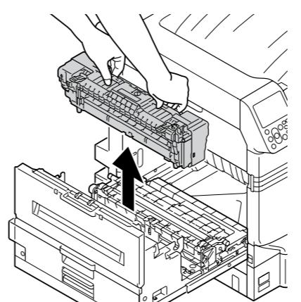
**8** Если бумага намоталась на ролик декалькомании, извлеките устройство для декалькомании, повернув влево баращковые винты с обеих сторон устройства для декалькомании, и извлеките бумагу.
