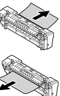
**10** Если бумага намоталась на ролик декалькомании, извлеките устройство для декалькомании, повернув влево барашковые винты с обеих сторон устройства для декалькомании, и извлеките бумагу.
