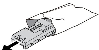
5 Установите новую емкость для отработанного тонера в принтер.
