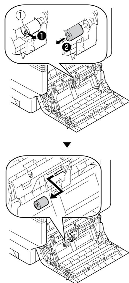
**6** Приподнимите Отсек А, откройте зажимы в соответствующем направлении, как показано на рисунке, и извлеките ролики подачи бумаги (②).
