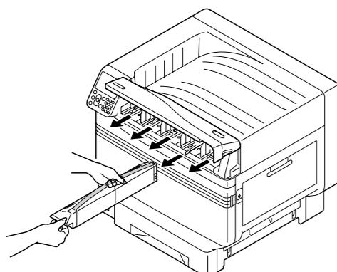
**4** Проверьте рычаги определения тонер-картриджей (четыре рычага для моделей CS4000 и пять рычагов для модели CS5000).
