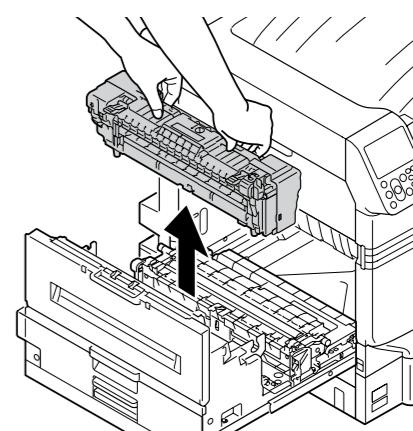
**7** Если в блоке печки произошло замятие бумаги, поднимите стопорный рычаг (синий) и медленно потяните бумагу в направлении, противоположном рабочему.
