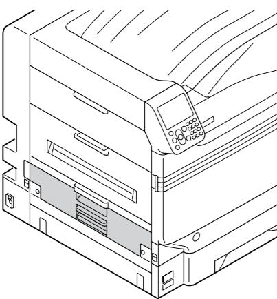
**4** Приподнимите рычаг блокировки (①) выходного блока и извлеките его.
