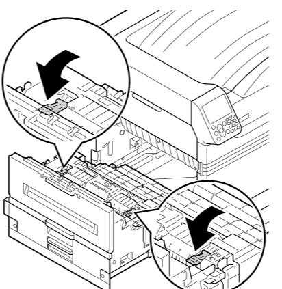
**5** Если в термофиксаторе не осталось бумаги, потяните фиксирующий рычажок термофиксатора (синий).
