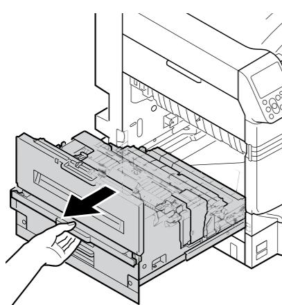
**15** Потяните за края фиксирующего рычага ролика переноса изображения (синий).
