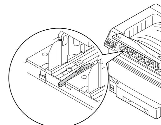
**5** Поднимите рычаги определения тонер-картриджей.
