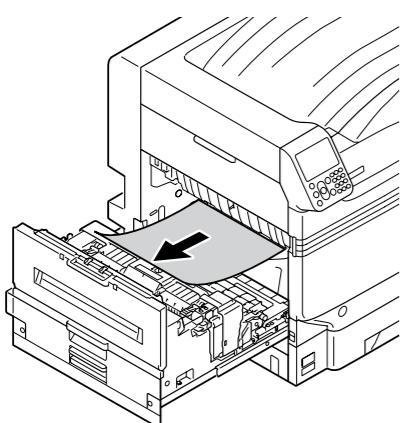
**3** Если в термофиксаторе осталась бумага, потяните рычаг высвобождения замятой бумаги соответствующего блока (синий).
