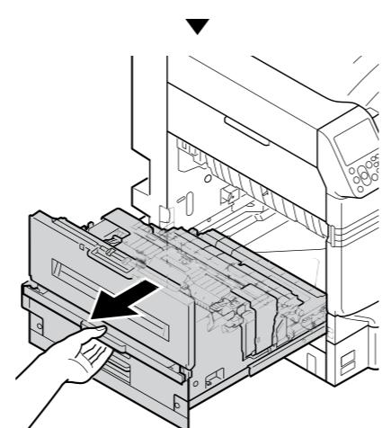
**2** Если в термофиксаторе осталась бумага, потяните рычаг высвобождения замятой бумаги соответствующего блока (синий).
