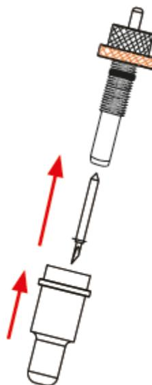
3. Отрегулируйте количество оголенного (видимого) кончика лезвия до подходящей длины, вращая ② "Глубина регулировки ручку", а затем затяните фиксатор ③.
