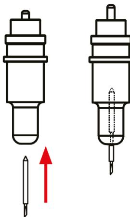
2. Отрегулируйте количество открытого (видимого) лезвия кончика до подходящей длины путем вращая ② "Регулировка ручка глубины", а затем затяните замок ③.
