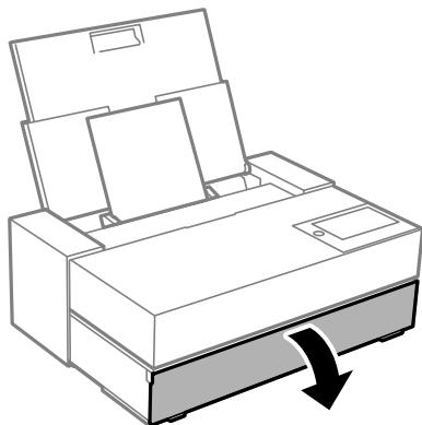
7. Выдвиньте выходной лоток в максимальное положение.
