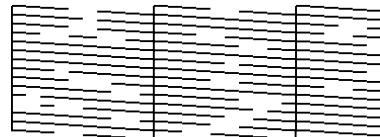
Если на шаблоне присутствуют пропуски, выполните прочистку печатающей головки.
