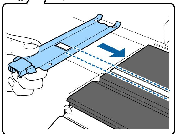
(2) При прижатии конца металлической пластины к валу прикрепите загнутую секцию к переднему углу вала.
