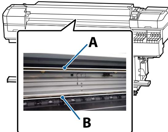
Есть два стержня каратки: стержень А и стержень В. Нанесите смазку на оба стержня, используя комплект для смазки, входящий в комплект поставки принтера.
