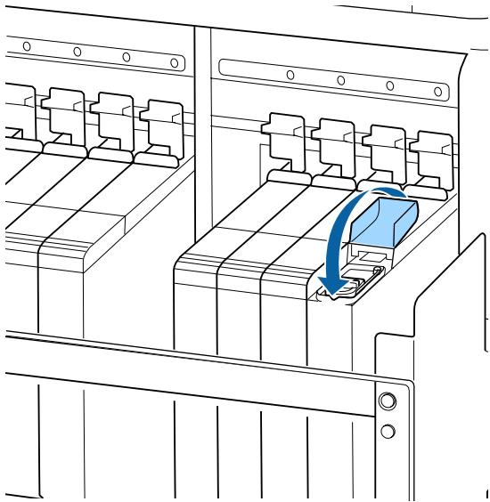
Если чернила налипают на теплоизоляционную защиту при перезаправке чернил, снимите теплоизоляционную защиту и очистите ее.
