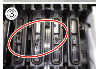
Как показано на фотографиях (1) и (2), если волокна и пыль прилипают к области вокруг печатающей головки, шляпкам или скребкам, может происходить закупоривание дюз во время печати. Более того, если волокна или пыль остаются, закупорки дюз нельзя очистить даже после повторной чистки головки. Также, если несколько капель чернил попадает на шляпку, как показано на фотографии (3), может произойти закупорка дюз.
