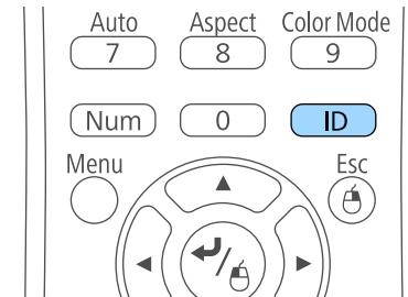
На проецируемом экране отображается ID текущего проектора. Приблизительно через 3 секунды он исчезнет.
