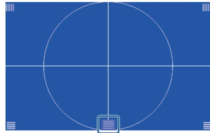
**7** Проверьте фокусировку по углам проецируемого экрана.
