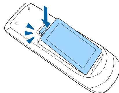
В каждое перо устанавливается батарея типоразмера АА.
