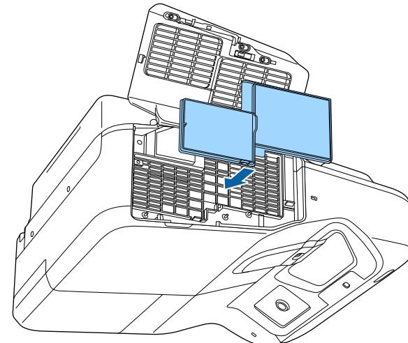
**5** Закройте крышку воздушного фильтра.
