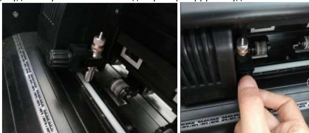
6. Загрузите небольшой отрезок материала в режущий плоттер.
