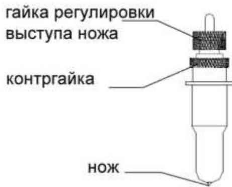
Необходимо выбирать выступ ножа, в соответствии с толщиной разрезаемого материала. Выступ лезвия ножа должен быть чуть больше толщины плёнки. Нож не должен прорезать подложку самоклеящейся плёнки.
