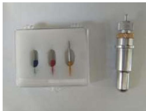
1. Откройте бокс с ножами и выберите нужный нож. Ножи различаются по углу заточки: синий - 30°; красный - 45°; жёлтый - 60°. В зависимости от толщины и плотности материала в держатель устанавливаются ножи с соответствующим углом. Чем толще материал, тем больше угол заточки. Выбор производится опытным путём.
