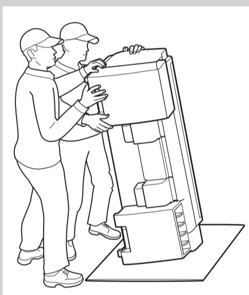
• При поднятии принтера или его удерживании держитесь за металлические части принтера. Удерживание принтера за пластиковые части может привести к его повреждению.
