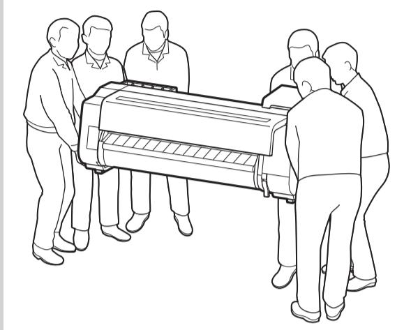
• При перемещении принтера крепко удерживайте его за ручки для переноски (A) с каждой стороны. Удерживание принтера в других положениях опасно и может стать причиной травмы или повреждения при падении принтера.
