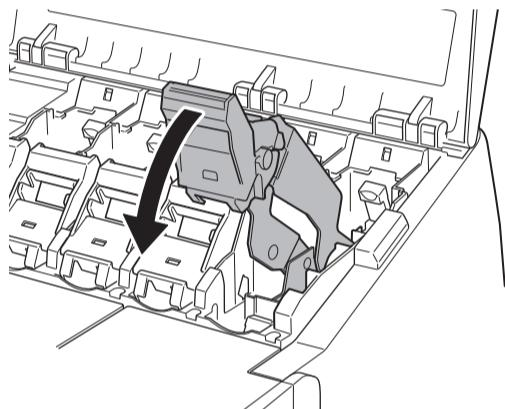
③ Надежно закрепите рычаг в положении, в котором он остается зафиксированным, когда вы убираете руку.
