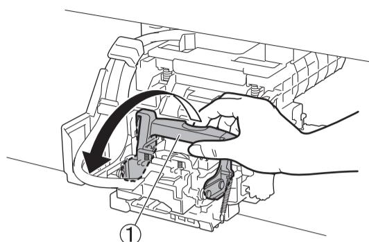
**3** Откройте фиксирующую крышку печатающей головки ②, придерживаясь инструкций на экране, и коснитесь **OK**. Не касайтесь контактов (A) на каретке.
