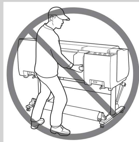
• Установка или перемещение принтера с нагрузкой только по центру может привести к повреждению принтера.
