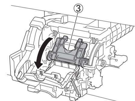
**8** Надавите на фиксирующий рычаг печатающей головки ④ до упора.
