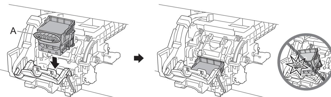
**7** Потяните крышку фиксирующей крышки печатающей головки ③ вниз и вперед, чтобы зафиксировать печатающую головку на месте.
