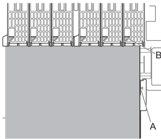
**5** Опустите спусковой рычаг, чтобы зафиксировать бумагу, и закройте верхнюю крышку.
