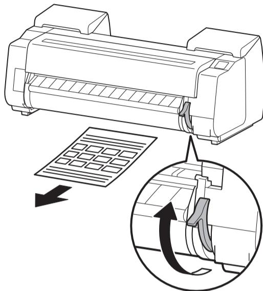
**3** Загрузите следующие листы, выполняя действия пунктов 2-5 на стр. 9. Для регулировки печатающей головки используется 5 листов бумаги. Повторяйте действия пунктов 2 и 3 до завершения печати.
