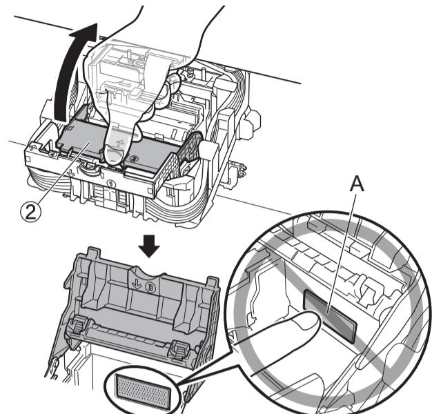
**4** ① Извлеките печатающую головку из коробки и пакета и снимите крепежную ленту.
