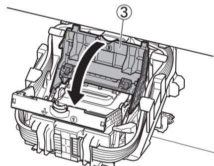
**8** Надавите на фиксирующий рычаг печатающей головки ④ до упора, пока не раздастся щелчок.
