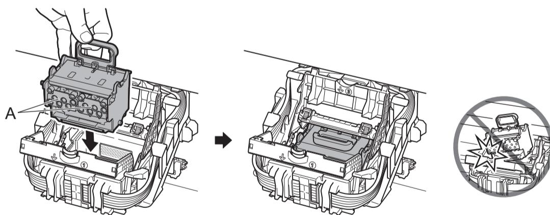
**7** Потяните крышку фиксирующей крышки печатающей головки ③ вниз и вперед, чтобы зафиксировать печатающую головку на месте.
