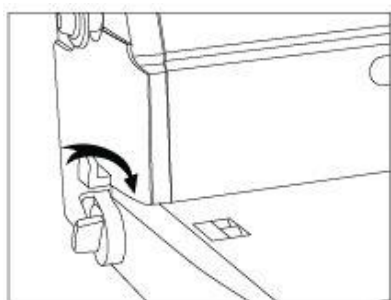
Рис.7 Приведите штифт позиционирования пробиваемых отверстий больших форматов в рабочее положение
