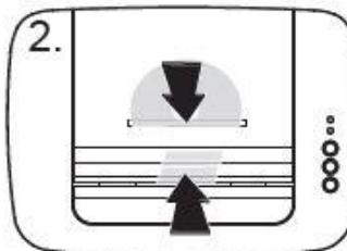
Вставьте пластиковую карту или CD в проем загрузки. Аппарат автоматически начнет измельчение
