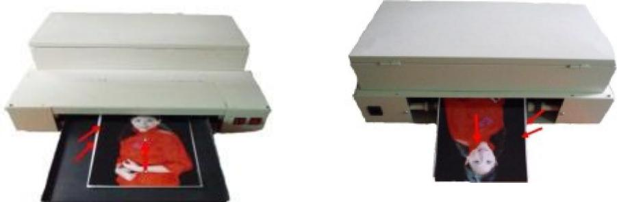
7. Слой лака можно самостоятельно отрегулировать с помощью винта «2», указанного на рисунке. При вращении винта по часовой стрелке, расстояние между валами уменьшается, и слой нанесенного лака становится тоньше. При вращении винта против часовой стрелки, расстояние между валами увеличивается, и слой нанесенного лака становится толще. Винт «1» регулирует расстояние между вертикальными валами под толщину материала.
