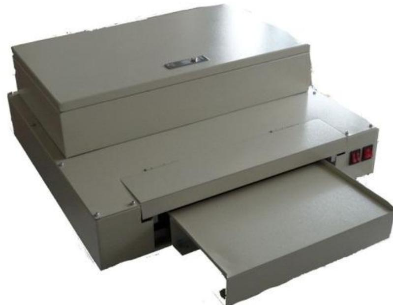
Мы благодарим вас за выбор лакировальной машины. Наша компания производит продукцию высокого качества и предлагает лучшее техническое обслуживание. Лакирование УФ лаком поверхности оттиска, осуществляются после печати. Тип лака, наносимый на оттиск, выбирается заказчиком в зависимости от ценовых и технологических требований.
