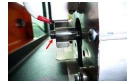
4. Каретка с лампой приводится в движение двигателем с ременной передачей от стопора до стопора, во время соприкосновения с которым двигатель меняет направление вращения. Ремень должен иметь среднее натяжение. Если каретка начинает хаотичное движение из стороны в сторону, отрегулируйте натяжение ремня вспомогательным роликом.
