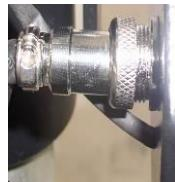
Открутите барабанную гайку при помощи которой крепится насадка, замените на нужную вам насадку и зафиксируйте с помощью гайки
