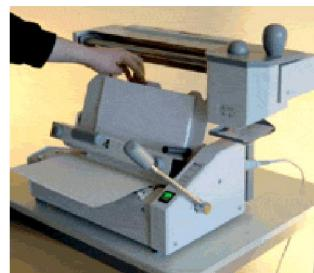
4. Зажать блок, сдвинув пресс-зажим вплотную к блоку, зафиксировать блок отжав ручки пресс-зажима, при этом пресс-зажим следует придерживать левой рукой (см. рис.).
