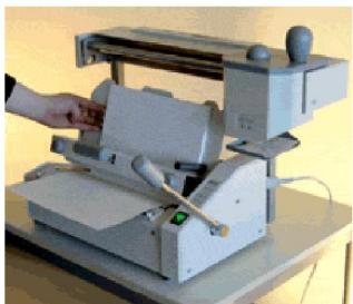
3. Придвинуть блок с обложкой вплотную к боковому упору. Подбить блок сбоку и сверху (см. рис.).
