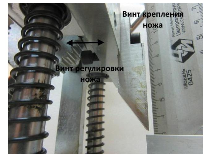
В процессе использования устройства кромка марзана срабатывает и его необходимо регулярно поправлять, устанавливая вплотную к режущей кромке ножа.
