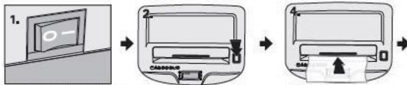
Перед использованием проверьте напряжение уничтожителя и включите его в сеть.
