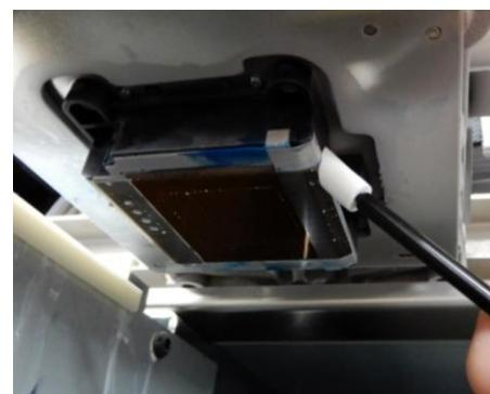
(4) Удалите смолистые отложения между поверхностью дюзы печатающей головки и предохранительной пластиной дюзы.
