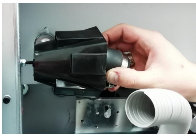
Рис. 103. Отвинчивание и снятие картриджа фильтра с корпуса
