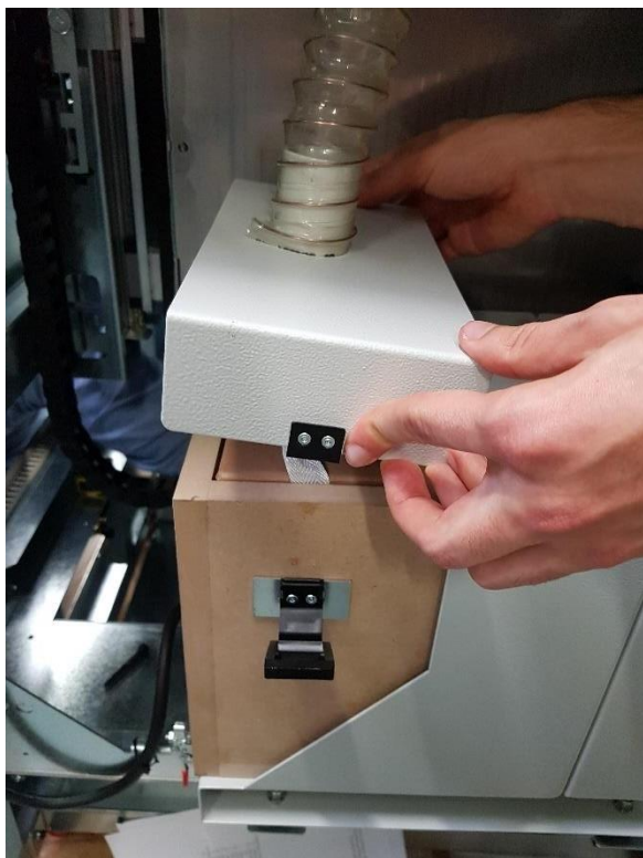
Рис. 119. Установка на место крышки фильтра
