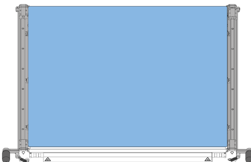
Рис. 61. Монтаж подогреваемой платформы - размещение стекла
