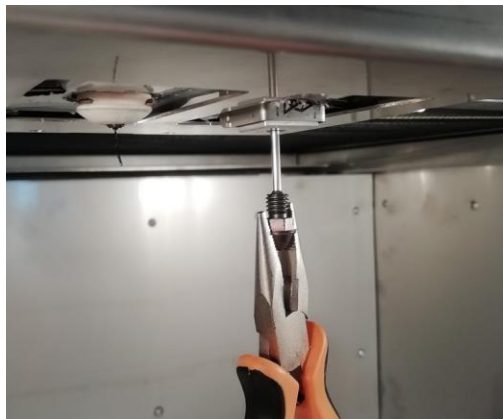
Рис. 80. Демонтаж печатающего сопла
