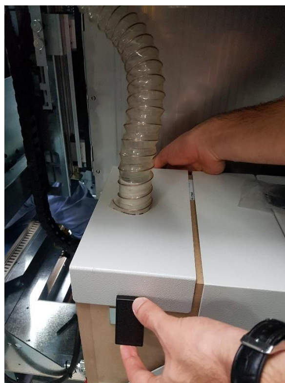
Рис. 112. Установка на место крышки фильтра
