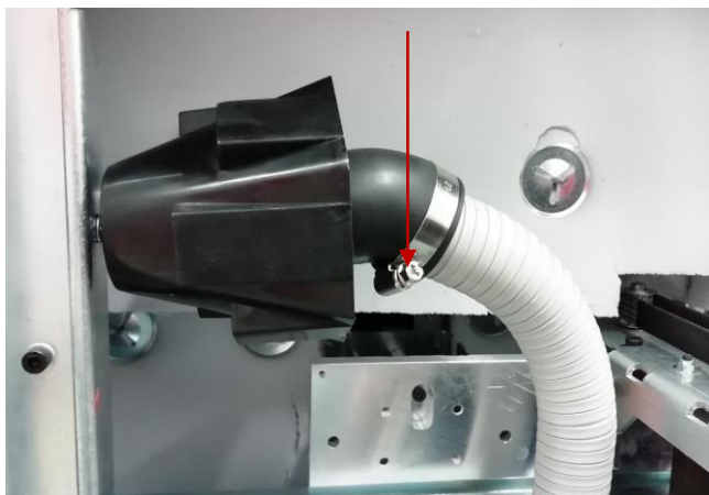
Рис. 102. Отвинчивание металлического зажима, которым крепится шланг подачи
