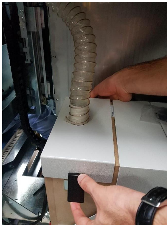
Рис. 119. Установка на место крышки фильтра
