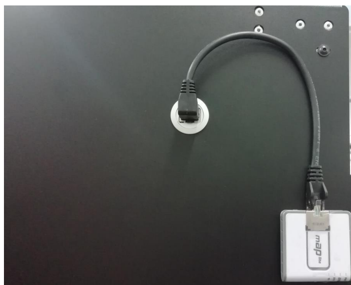
Рис. 12. Модуль беспроводной связи (WLAN), установленный на принтер
