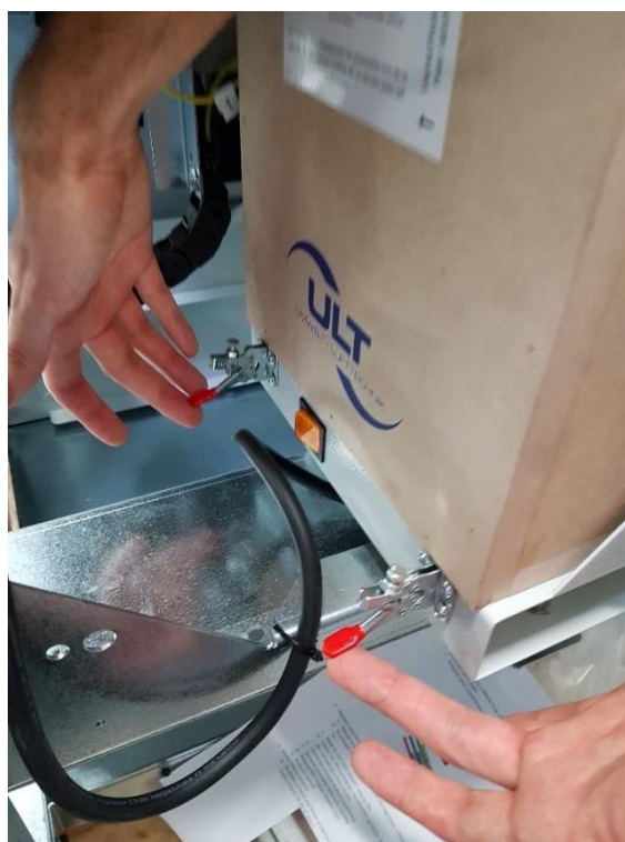
Рис. 116. Защелки, которыми крепится кассета
