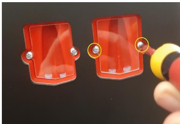
Рис. 107 Отвинчивание крепежных винтов, которыми крепится стекло отверстия для доступа
