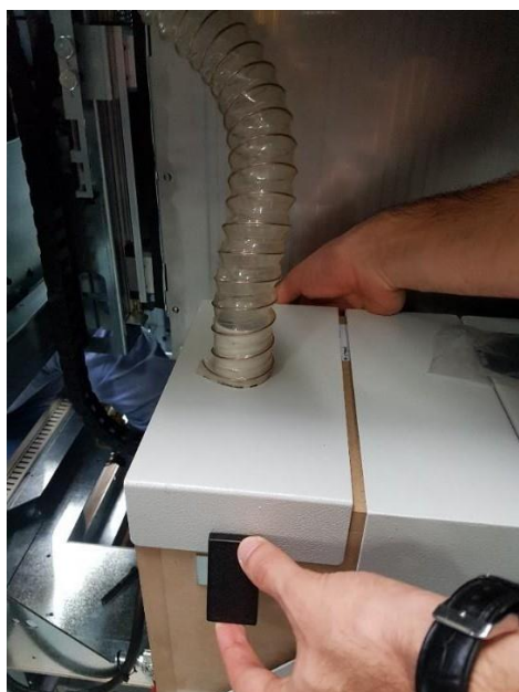
Рис. 114. Защелки, которыми крепится крышка фильтра
