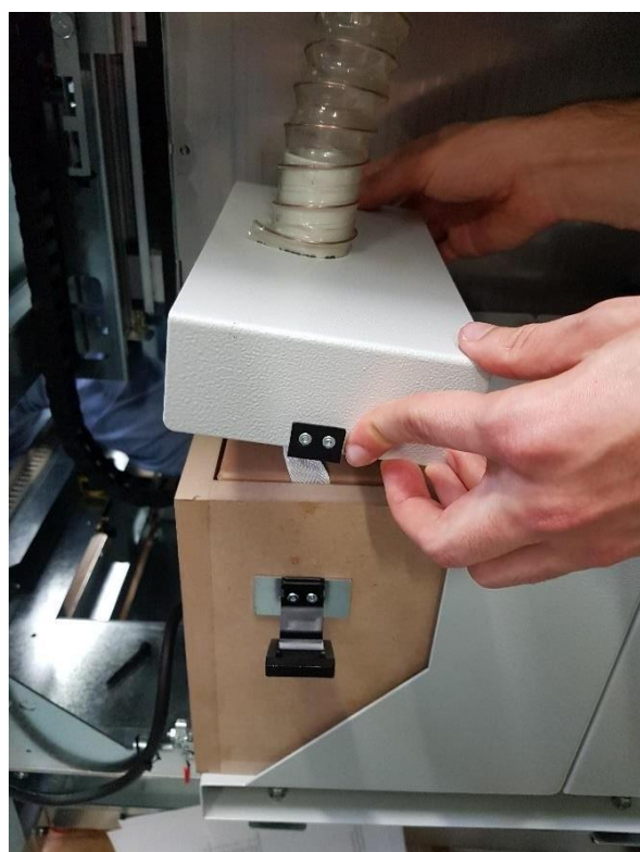
Рис. 112. Установка на место крышки фильтра
