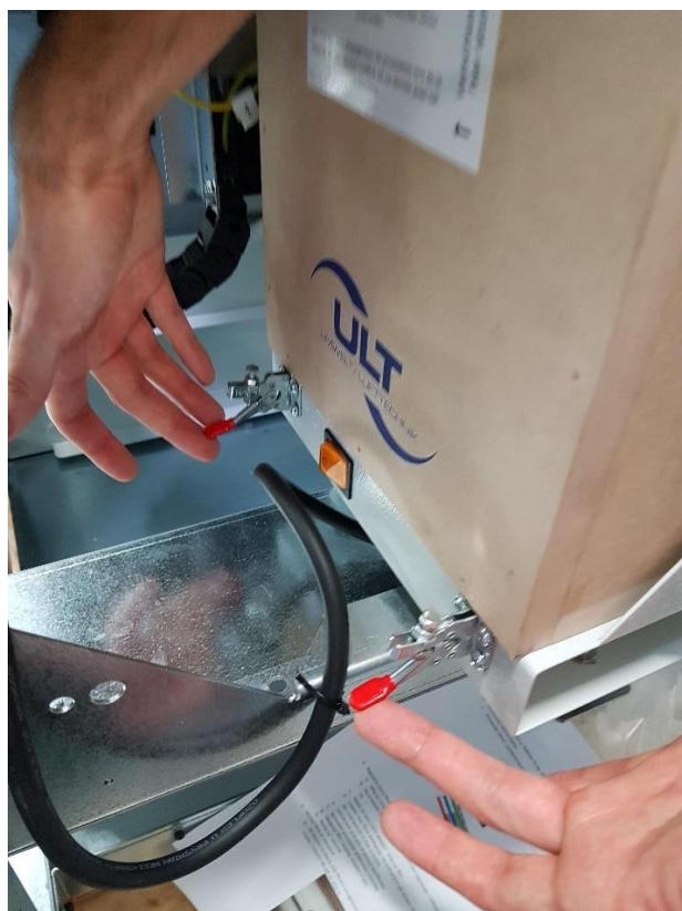
Рис. 118. Защелки, которыми крепится кассета
