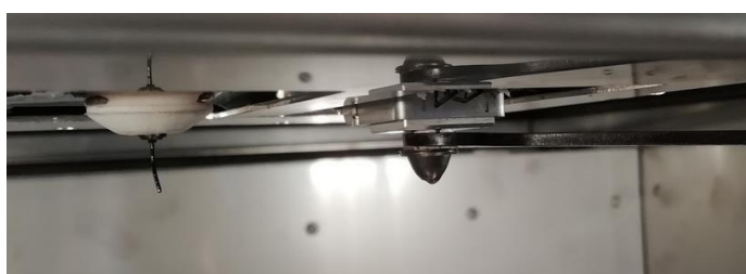
Рис. 79. Отвинчивание печатающего сопла
