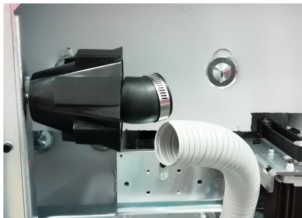
Рис. 102. Отвинчивание металлического зажима, которым крепится шланг подачи
