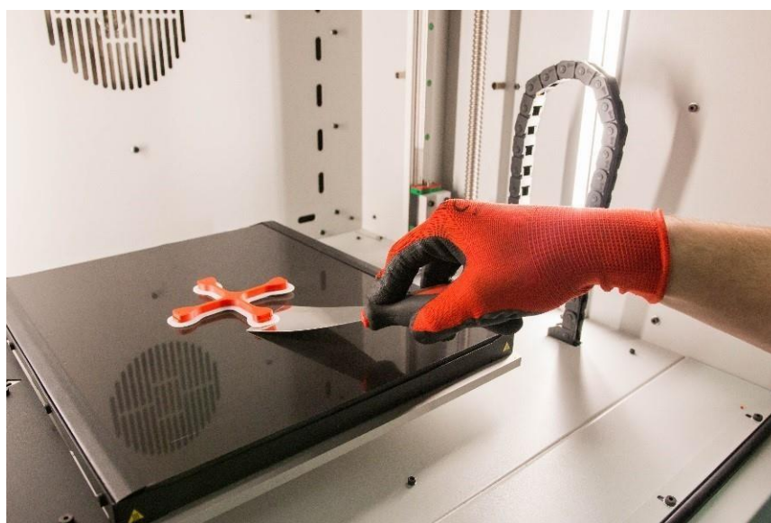
Рис. 66 Правильный способ снятия модели с принтера
