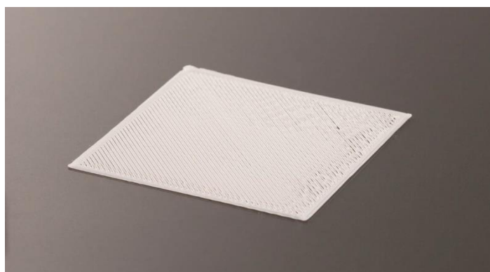
Рис. 65 Пример слишком низкого расположения нагревательного стола
