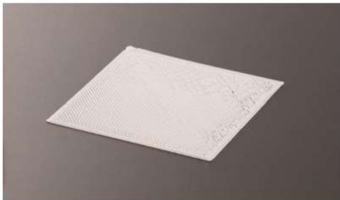
Рис. 44 Пример слишком низкого расположения нагревательного стола
