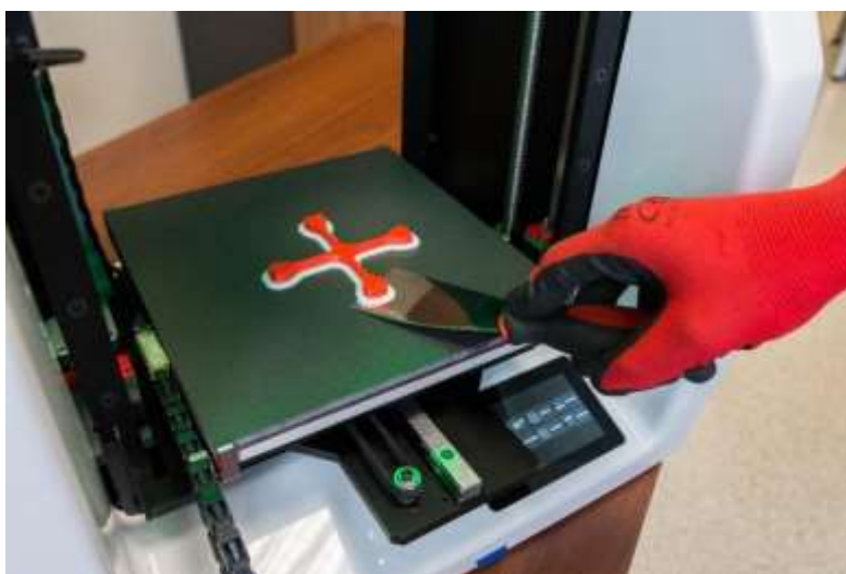
Рис. 45 Правильная процедура снятия модели с принтера
