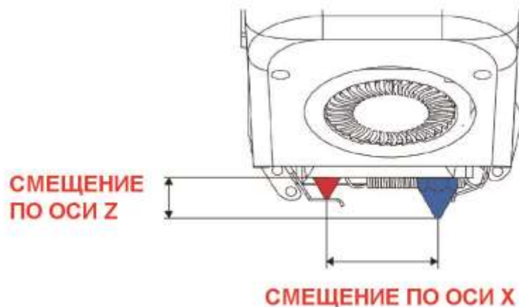
Рис. 61 Визуализация разницы положений сопел (смещений)
